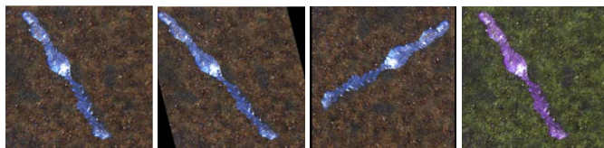
Рис. 2. Изображение дефекта «царапина» и результат аугментации
