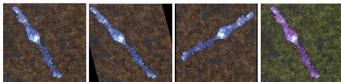
Рис. 2. Изображение дефекта «царапина» и результат аугментации
